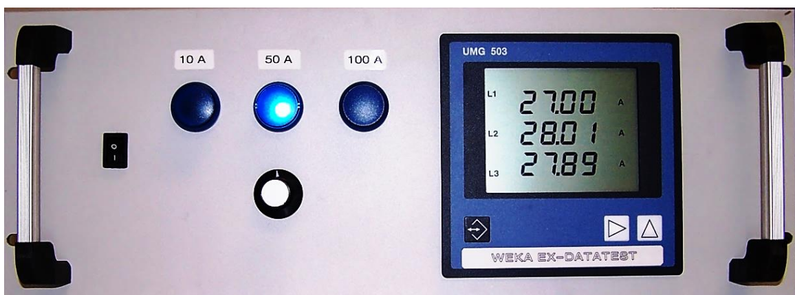
EX-DATA Messgerät im 19"/4 HE Einschub mit Umschalter für 3 Strommessbereiche
