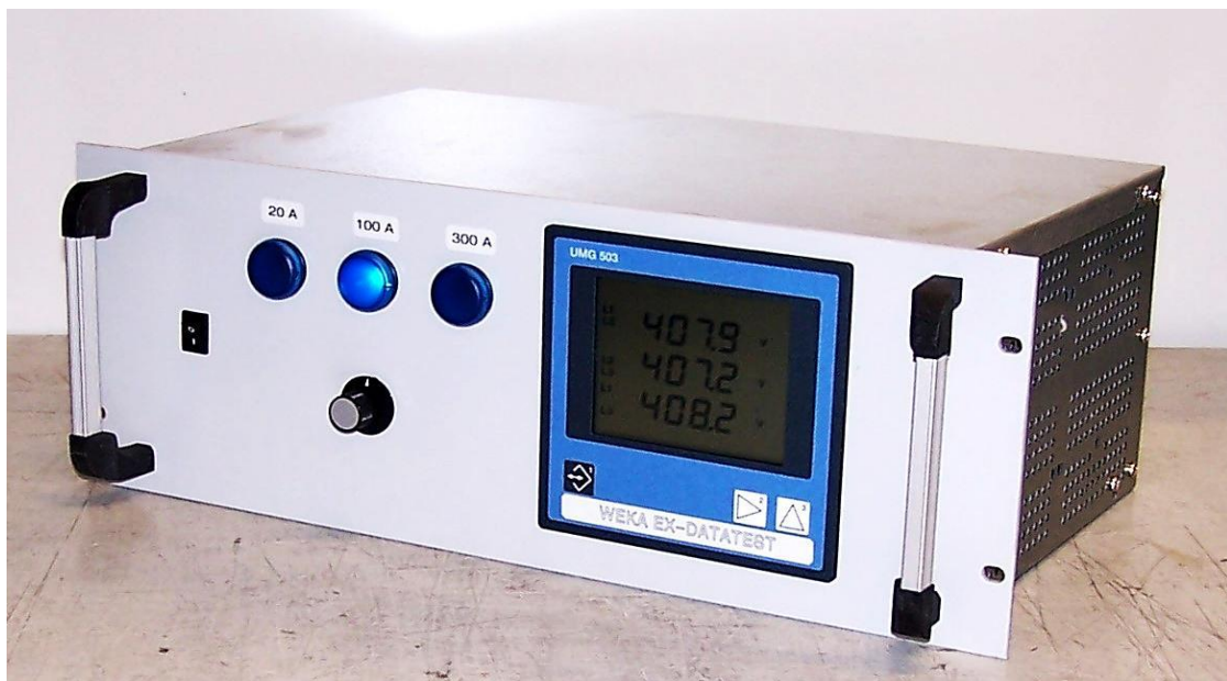
EX-DATA Messgerät im 19"/4 HE Einschub mit Umschalter für 3 Strommessbereiche
