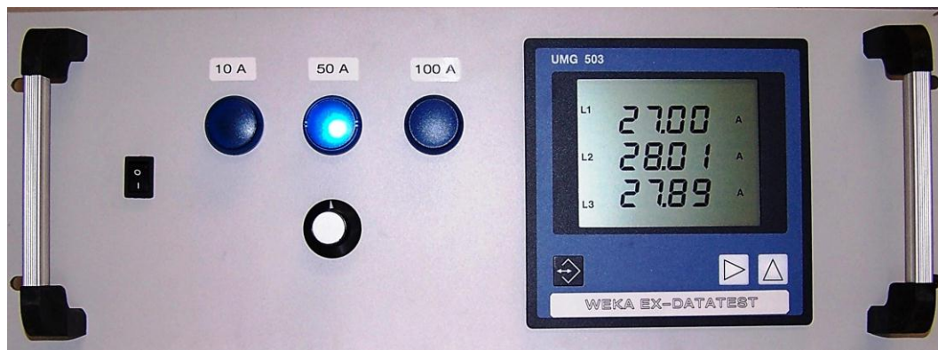
EX-DATA Messgerät im 19" Einschub mit Umschalter für Strommessbereiche
