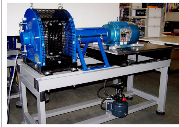
Leistungsprüfstand mit luftgekühlter Wirbelstrombremse und höhenverstellbarer Spannplatte
